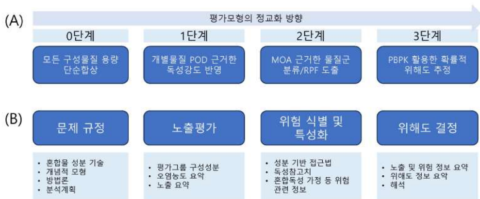
<그림 7.1> 다중 화학물질 복합 노출 평가 (A) 복합 노출 독성 예측을 위한 단계별 접근(Meek et al., 2011) (B) 성분 기반 접근법을 이용한 위해성 평가의 단계별 요약(Cattaneo et al., 2023)
